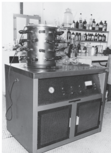
Figura 28: Liofilizador, destinado à recuperação de substâncias sólidas por secagem a frio e sob vácuo, de soluções congeladas de solventes volatilizáveis.
