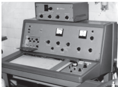
Figuras 34A e 34B: Ressonância Magnética Nuclear Varian A60, um dos primeiros modelos adquiridos no Brasil (1968). Na foto à direita, (foto de 1973) a professora Rosane San Gil.
