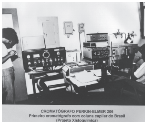
Figura 37: Primeiro cromatógrafo com coluna capilar no Brasil: modelo Perkin-Elmer 206, do Projeto Xistoquímica, na sala A-607 do bloco A do Centro de Tecnologia.
