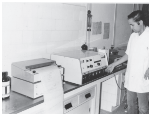
Figura 27 - Espectrofotômetro Ultravioleta-Visível Perkin-Elmer 202 e Hitachi-Perkin-Elmer 139, operados pelo professor Ricardo Bicca de Alencastro, Diretor do Instituto de Química entre 1976 e 1980, atualmente professor Titular do Departamento de Química Orgânica do IQ/UFRJ.
