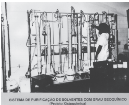
Figura 39: Unidade de destilação de solventes puros para o Projeto Xistoquímica, localizada no laboratório A-629a do bloco A do Centro de Tecnologia.
